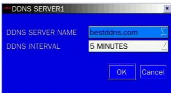
Рисунок 3.8.4. Экран настройки сети – DDNS Server 1
